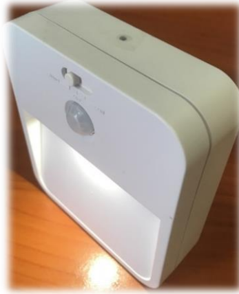
Figure 8-2: PIR and ALS in a Lighting Application
