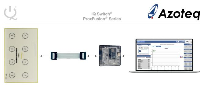
Figure 2.2: DS200 Connection for Streaming and Testing
