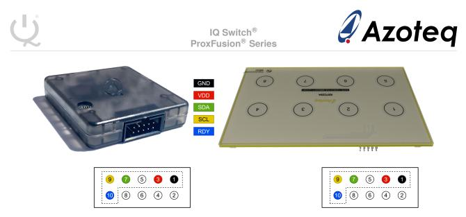
Figure 2.4: DS200 Power, I<sup>2</sup>C and RDY Connections
